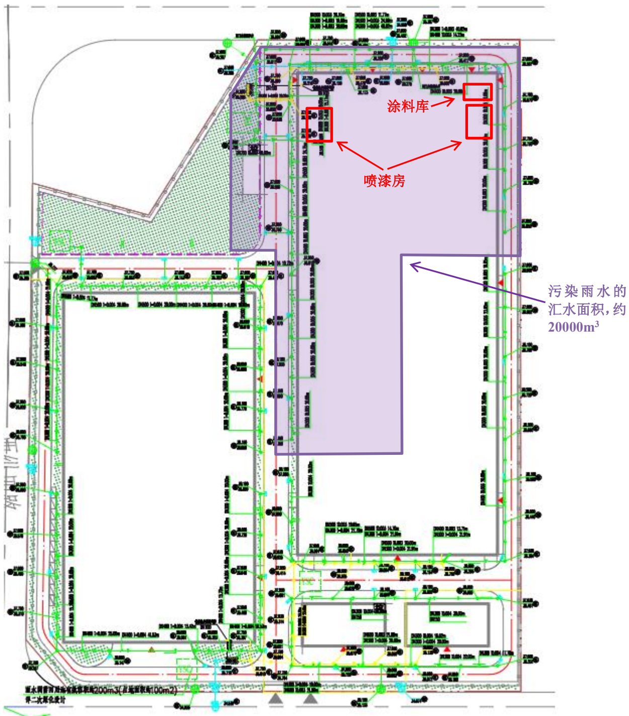
附图11 厂区排水管网图
