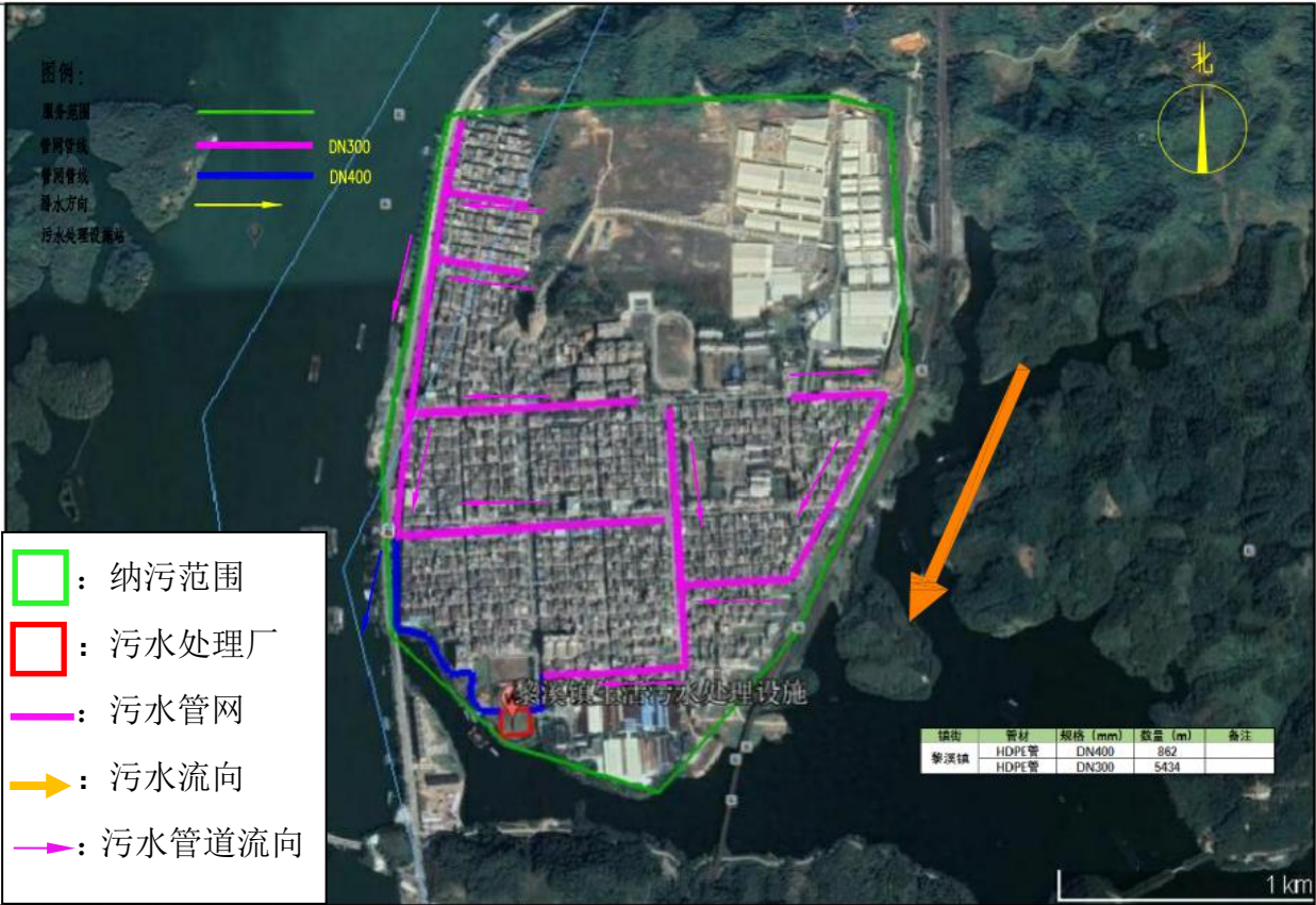
图1-2 工程纳污范围及管网管线
