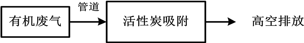
图 4-1 废气处理流程示意图
