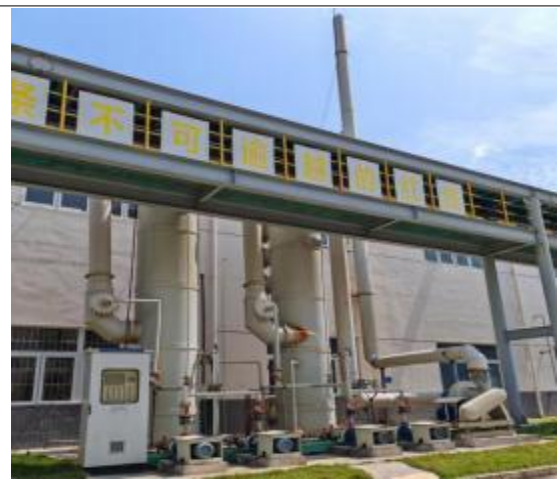
氟钽酸钾车间转化烘干废气：二级碱液喷淋塔
