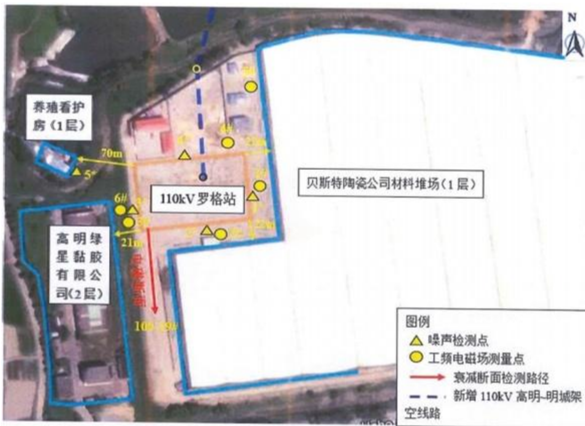
图 2 佛山 110 千伏罗格变电站监测布点图
