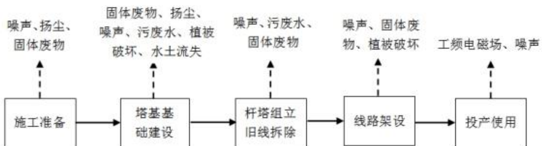
图 2-2 架空线路工程工艺流程及产污环节
