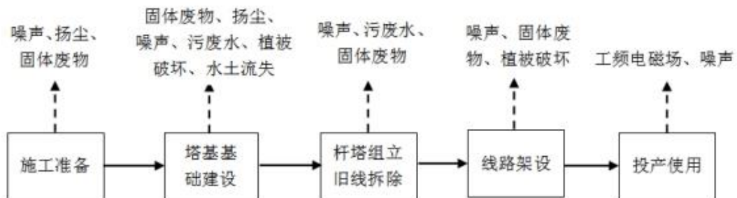
图 2.11-2 架空线路主要工艺流程及产污环节图
