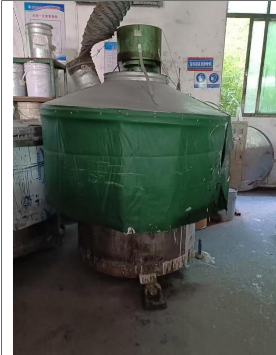
图 2-7 分散工序废气收集措施处理效率：
