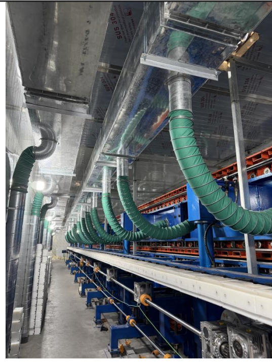
双履带输送设备（熟化设备，放置在密闭的发泡熟化间）
