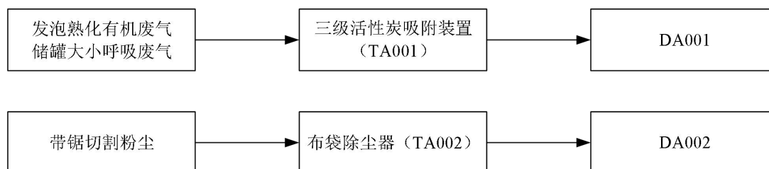
图 4-1 本项目废气处理工艺流程图
