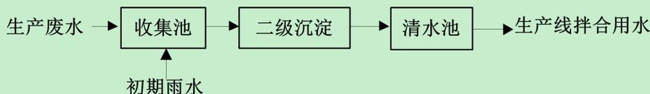
图 7 项目生产废水处理工艺流程
