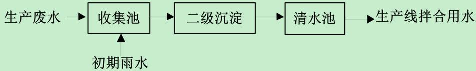
图 8 项目地面初期雨水处理工艺流程
