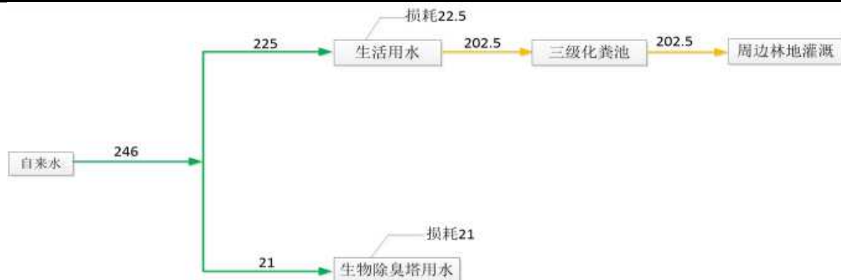
图 2-8 现有项目给排水平衡图（单位：m 3 /a）
