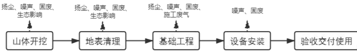
图 1 项目施工期工艺流程及产污环节图
