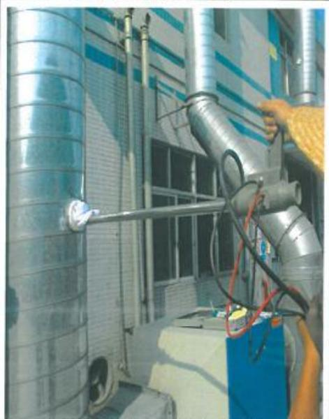
图 7.5 甲类 A1 车间 (配料车间) 搅拌工序废气处理前检测口 ©Q5
