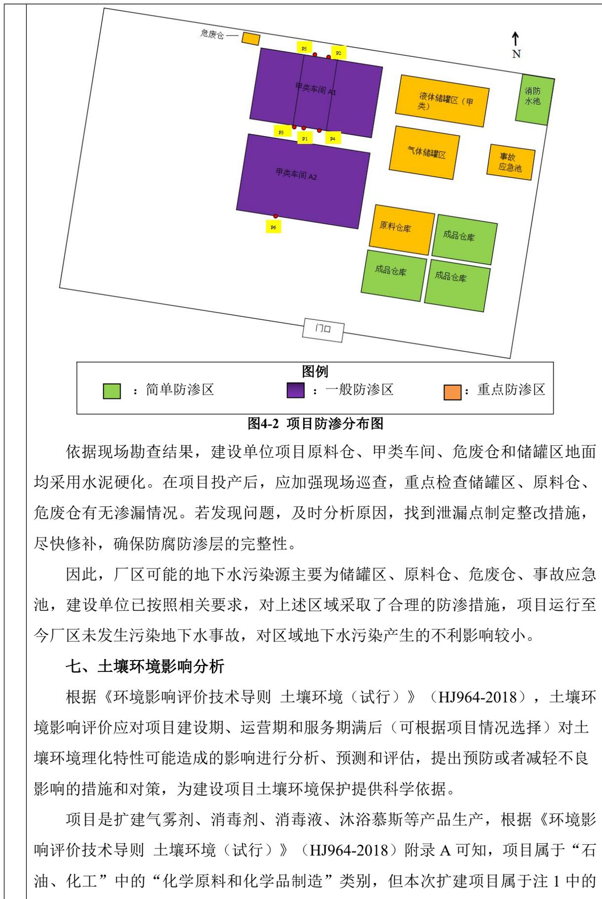
依据现场勘查结果，建设单位项目原料仓、甲类车间、危废仓和储罐区地面均采用水泥硬化。在项目投产后，应加强现场巡查，重点检查储罐区、原料仓、危废仓有无渗漏情况。若发现问题，及时分析原因，找到泄漏点制定整改措施，尽快修补，确保防腐防渗层的完整性。
