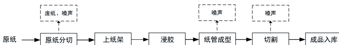
图2-7 纸管工艺流程及产污分析图
