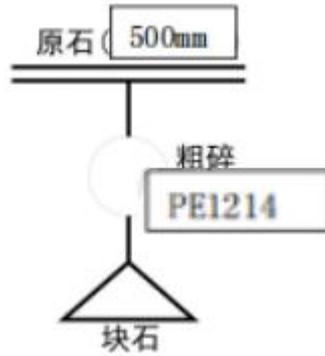
图 2-7 中风化层破碎工艺流程图
