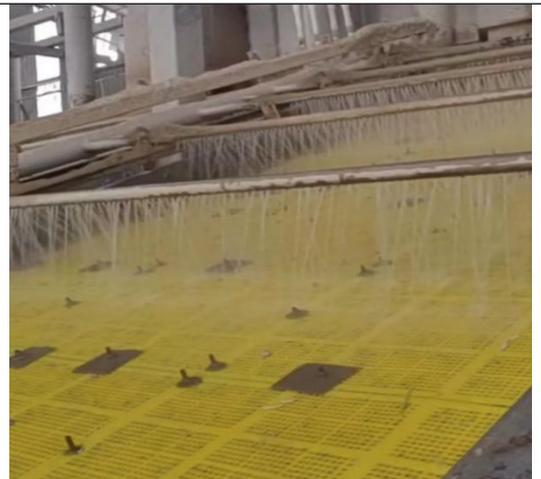
图 2 成品筛分设备进行水洗筛分效果图
