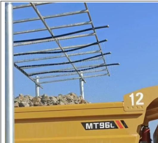
图 1 高架式喷淋设备效果图
